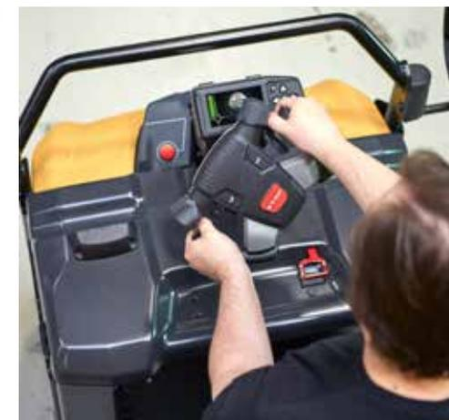
Esses guinchos potentes com capacidade de 3 e 5 toneladas apresentam tecnologia inteligente que se baseia no Sistema de Direção Responsiva (RDS) Cat®. A direção adaptável, o controle inteligente de curvas e a otimização automática de tração, aceleração e frenagem garantem uma direção suave, precisa e agradável.
